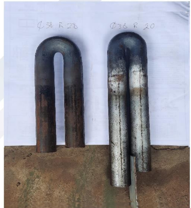
(Fabrikasi bending U-Bend R20 mm & R 28 mm)
