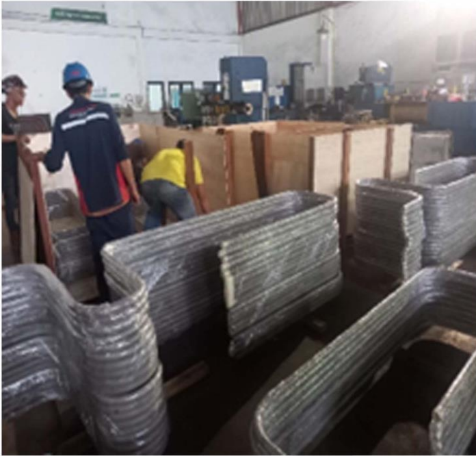
(Fabrikasi Inlet Pigtail PKT Kaltim 5 )
